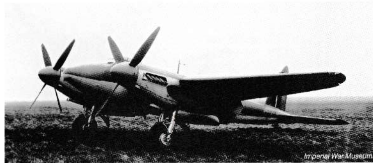
●海軍仕様のシーモスキートTR Mk.33。プロペラが4枚となり、魚雷も搭載可能だった。 The Navy's TR Mk.33 Sea Mosquito had 4-bladed propellers and could carry a torpedo.
