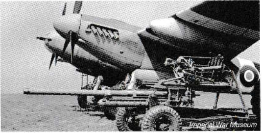
●機首を改修し、6ポンド対戦車砲を搭載したモスキートFB Mk.18 "ツェツェ"。 The Mk.18 "Tsetse" employed a 6-pounder anti-tank gun in the nose.
