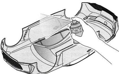
5 ★塗料が乾いたら、ウィンドウ部分のマスクシールをはがし、お好みでスモーク(PS-31)を塗装します。
