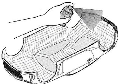
3 ★ボディを内側からブラック(PS-5)で塗装します。スプレー塗装はボディから30cmほどはなし、一度に塗らず数回に分けて塗ります。
