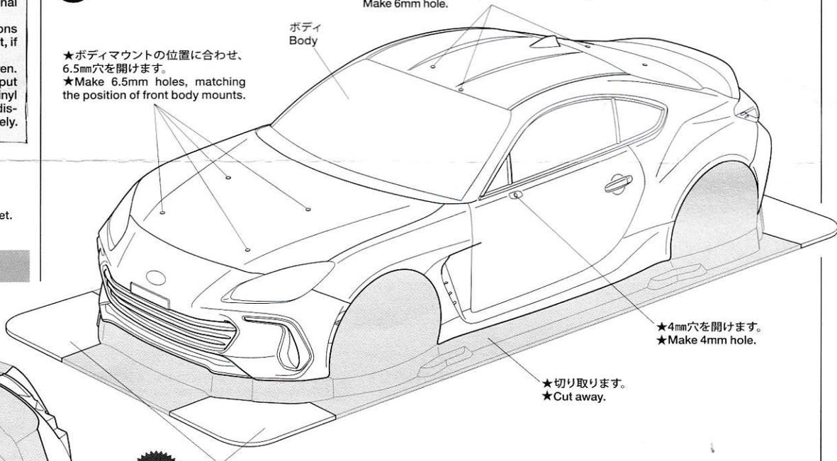
★アンテナを立てる場合は、アンテナマウントの位置に合わせて油性ペンなどでマーキングし、その位置に合わせて6mm穴を開けます。
