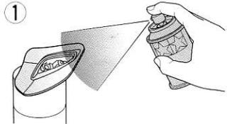
★パーツを中性洗剤で洗い、よく乾かした後、保護フィルムが貼られていない裏側を塗装します。
