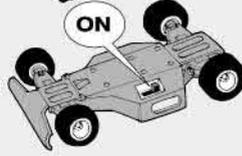
② ★ステアリングを使わず走らせて、まっすぐに走らない場合はステアリングトリムで調節してください。
