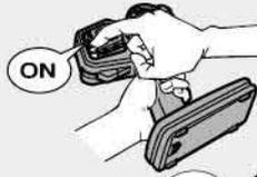
① ★送信機のアンテナをのばし、スイッチをONにします。次にRCカー側のスイッチをONにしてください。
