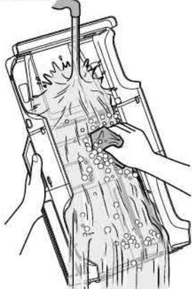
★塗装前に中性洗剤で油気をおとします。水洗いをして洗剤分を洗い流して乾かしてください。
