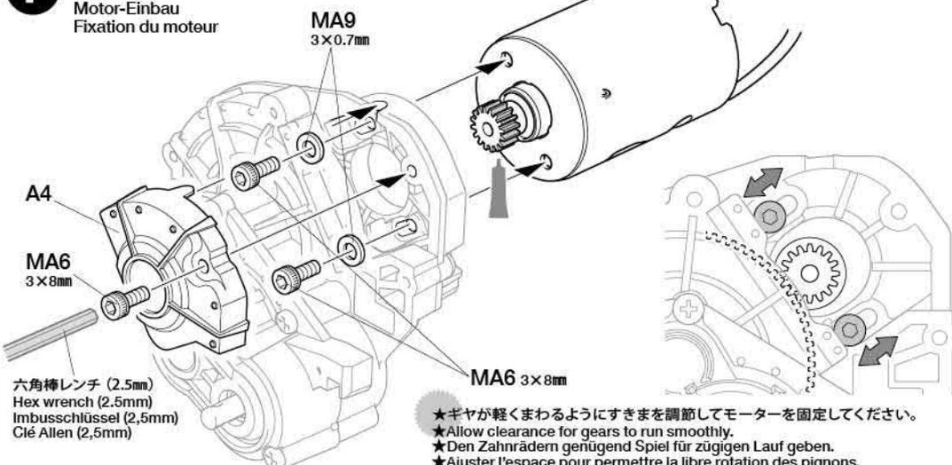
★ギヤが軽くまわるようにすきまを調節してモーターを固定してください。
