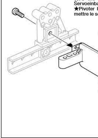
★下図のようにF5の向きを変えて取り付けすることでサーボを縦積みできます。
