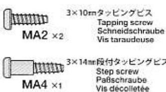
★段付ビス (MA4) は、アッパー・アーム (C4) の動きが悪くなるないようにネジ込みすぎに注意してください。
