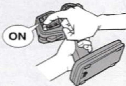
1 送信機のアンテナをのばし、スイッチをONにします。
