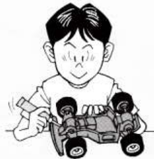
⑧ ギヤや軸受け部、サスペンションなどの可動部はグリスをさしておきましょう。
