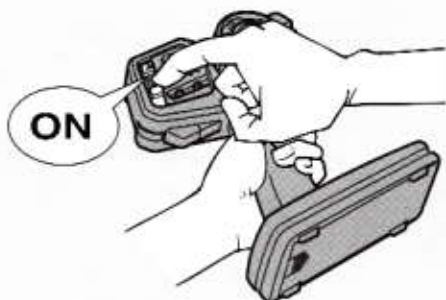
① 送信機のアンテナをのほし、スイッチをONにします。
