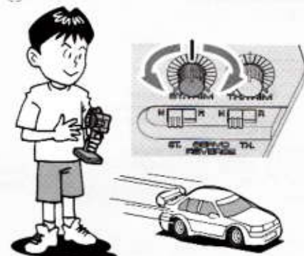
④ ステアリングを使わず走らせてみます。まっすぐに走らない場合はステアリングトリムを使って調節してください。
