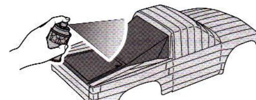
★ウインドウ部分のマスクシールをはがし、好みでPS-31(スモーク)で塗装します。塗料が乾いたらすべてのマスクシール、マスキングテープをはがします。
