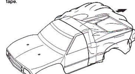
③ ★ボディを内側からブラック(PS-5)で塗装します。塗料が乾いたらウインドウ以外のマスキングテープをはがし、ガンメタル(PS-23)で塗装します。スプレー塗装はボディから30cmほどはなし、一度に塗らず数回に分けて塗ります。
