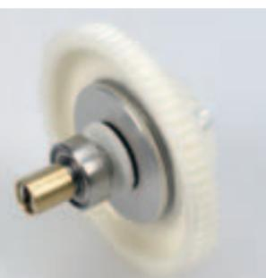
Im Hauptzahnrad auf der Zentralwelle ist ein Kugeldifferenzial untergebracht, dessen Sperrung den Drehzahlausgleich zwischen Vorder- und Hinterachse bestimmt
