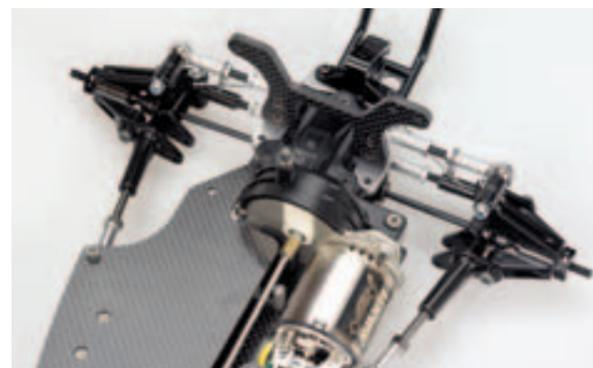
Schräglenker-Hinterachse mit vielfältigen Einstellmöglichkeiten
