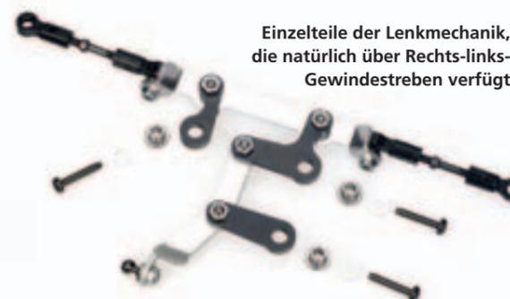
Einzelteile der Lenkmechanik, die natürlich über Rechts-links-Gewindestreben verfügt
