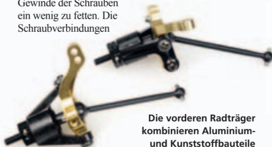
Die vorderen Radträger kombinieren Aluminium- und Kunststoffbauteile
