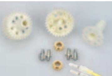
eingelaufen sind. Zum Einstellen des zentralen Kugeldifferenzials ist ein klein wenig Montageaufwand erforderlich, denn die Getriebegehäusekappe muss demontiert werden. Alle anderen Einstellungen am Buggy sind aber leicht zugänglich. Mit einem modernen LiPo-Akku bestückt, bietet der Buggy eine ordentliche Performance.
