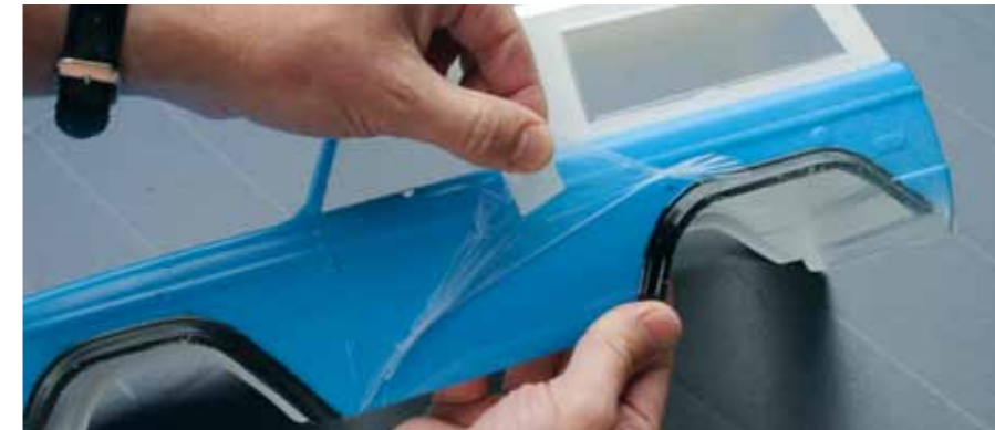
Nach dem Lackieren von innen wird die außen liegende Schutzfolie abgezogen, die die Außenhaut vor störendem Sprühnebel schützt
