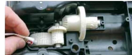
Das dreistufige Getriebe mit den großzügigen Kunststoffzahnradern erweist sich im Betrieb als sehr robust, will aber ausreichend mit Fett versehen werden
