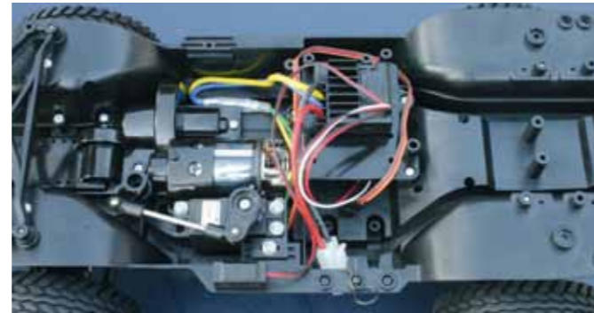
Der Tuningantrieb: LRP-Truckpuller mit niedrigerer Enddrehzahl und mehr Drehmoment verbessert das Fahrverhalten und ersetzt den Tamiya-typischen Baukastenmotor
