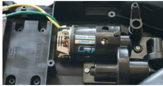
Der Tuningantrieb: LRP-Truckpuller mit niedrigerer Enddrehzahl und mehr Drehmoment verbessert das Fahrverhalten und ersetzt den Tamiya-typischen Baukastenmotor
