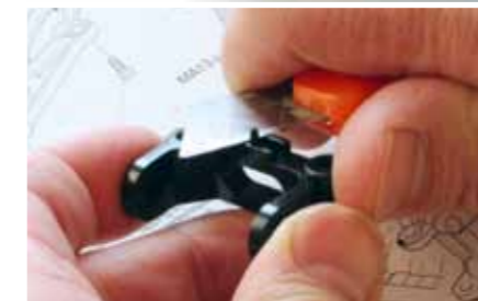
Der Anschlag an den vorderen Achsschenkeln kann zur Erhöhung des Lenkeinschlags entfernt werden
