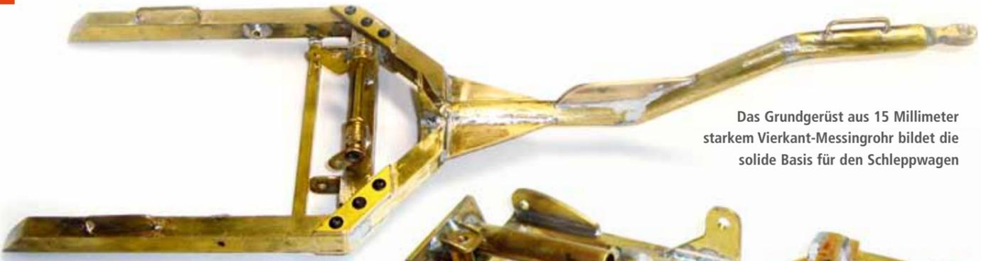
Das Grundgerüst aus 15 Millimeter starkem Vierkant-Messingrohr bildet die solide Basis für den Schleppwagen
