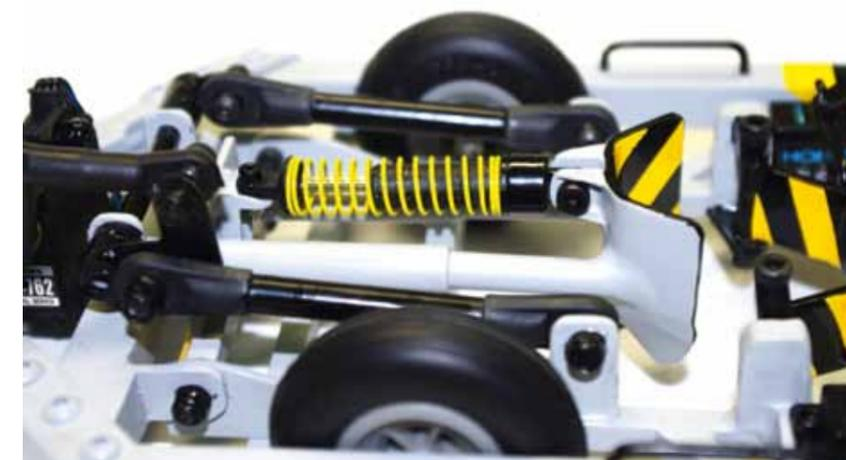
Der Stoßdämpfer am Radschuh stammt von einem RC-Car im Maßstab 1:18. Er ergänzte auch optisch den Schleppwagen hervorragend, zudem funktioniert er durch seine Leichtgängigkeit einwandfrei
