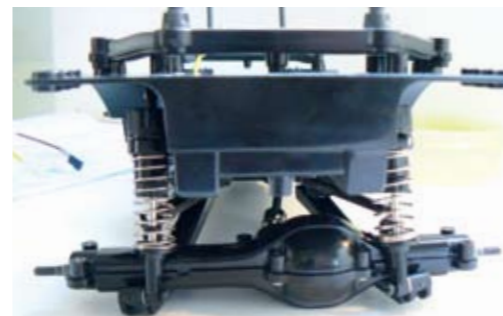
Fertig eingebaute Hinterachse
