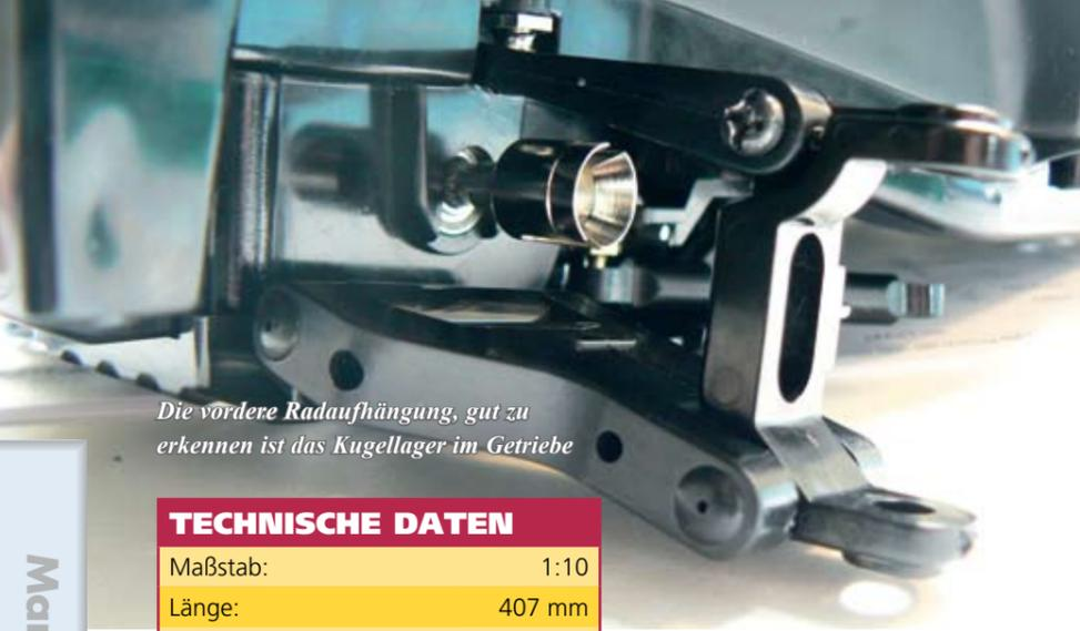
Die vordere Radaufhängung, gut zu erkennen ist das Kugellager im Getriebe
