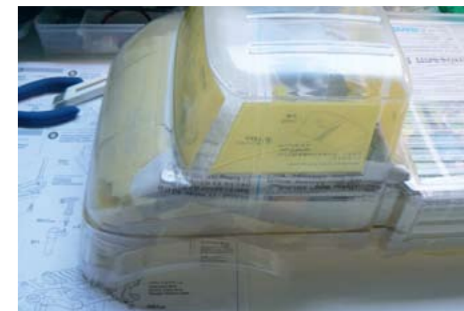
Fertig abgeklebte Unimog-Karosserie
