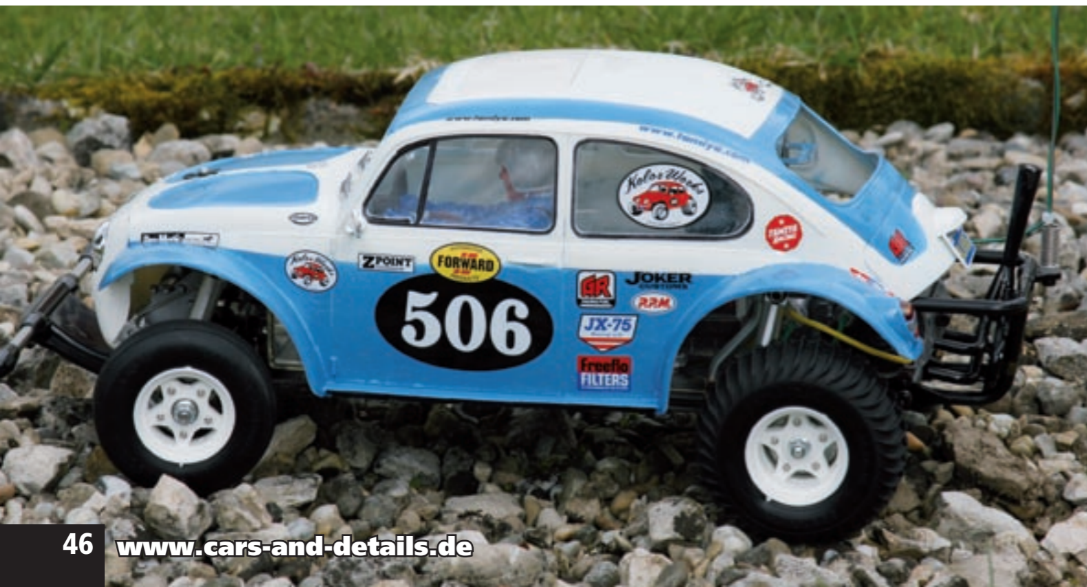
An der Vorderachse kommen kugelgelagerte Buggy-Rillenreifen mit sehr geringem Rollwiderstand zum Einsatz
