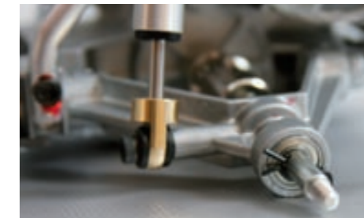
Auch die komplette Hinterachse läuft in kugellagerten Radachsen
