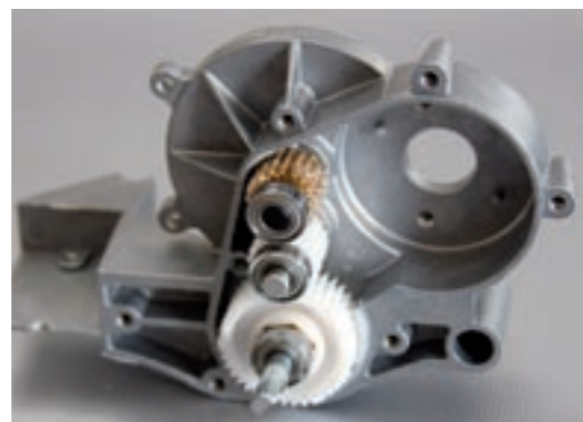
Das Getriebe ist komplett kugellagert
