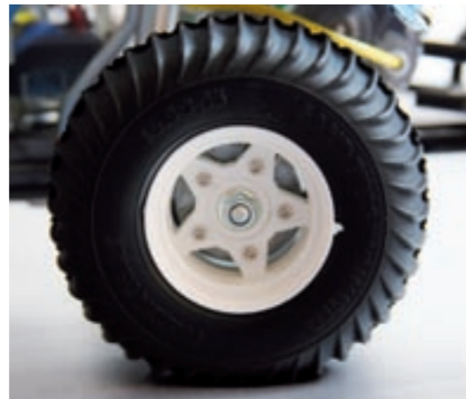
Die Paddle-Reifen fürs Heck bieten guten Grip und Vortrieb im Gelände, fahren sich jedoch recht schnell ab
