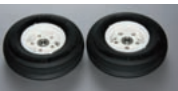
An der Vorderachse kommen kugelgelagerte Buggy-Rillenreifen mit sehr geringem Rollwiderstand zum Einsatz
