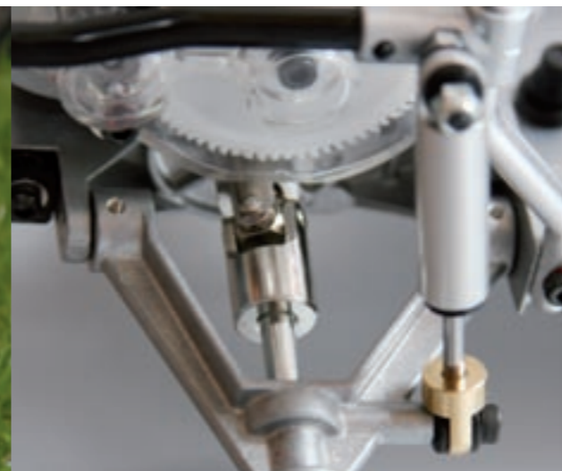
Massive, polierte Kardangelenke übertragen die Motorleistung auf die Räder
