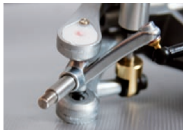
Die Lenkhebelträger sind auf Kugelköpfen gelagert und weisen daher kaum Reibung auf
