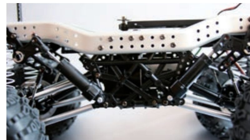
Es stehen zahlreiche Aufhängungspunkte an den Chassisstreben für die Dämpferaufhängung zur Verfügung. Das Fahrzeug kann dadurch sehr flexibel abgestimmt werden
