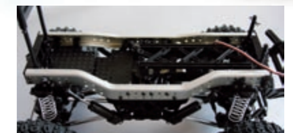
Die Alustreben bilden eine sehr verwindungssteife Basis für das gesamte Modell und bieten zudem ausreichend Platz für die RC-Komponenten
