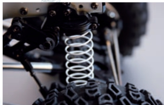
Es können Federn in verschiedenen Härtegraden montiert werden, um das Fahrzeugsetup noch zu verfeinern
