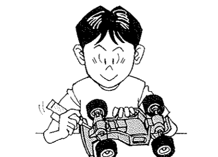
⑧ ギヤや軸受け部、サスペンションなどの可動部はグリスをさしておきましょう。
