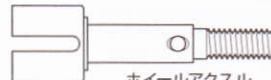
MA14 ×1 19405619 プロペラジョイント Propeller joint Antriebs-Gelenk Accouplement d'arbre de transmission
