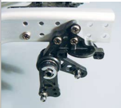
Die Spiralfederaufnahme und der Umlenkhebel für die inneren Stoßdämpfer
