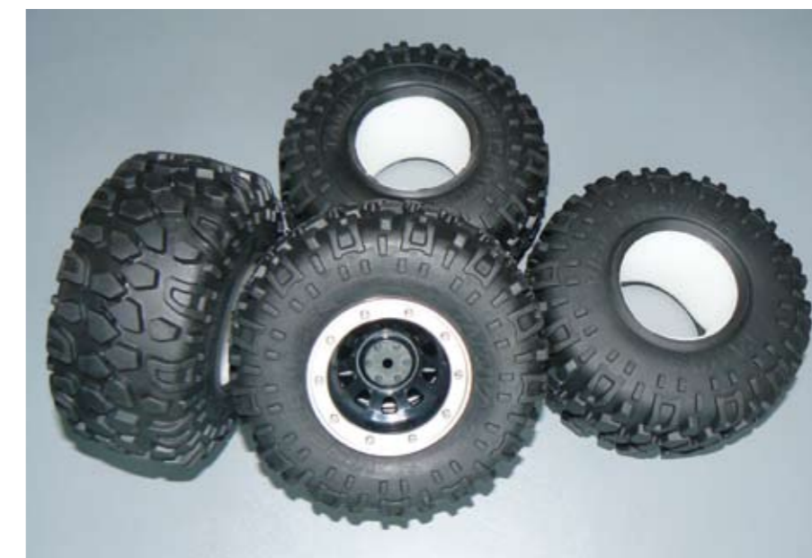
Die Trial-Reifen sind schon mit einer Schaumstoffeinlage gefüllt, reichlich Schraubarbeit für die Beadlock-Ringe
