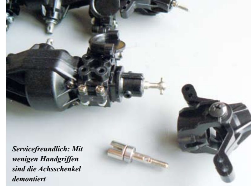
Ein Gemisch aus Aluminium, Metall und Kunststoff ergibt eine stabile Einheit
