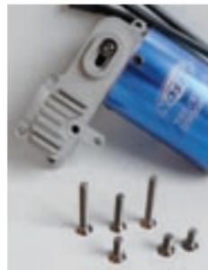
Die Passgenauigkeit des Motorhalters ist wirklich erstklassig, dennoch sollte man aufpassen, die vier unterschiedlich langen Schraubensorten nicht falsch zu montieren, sonst ist schnell mal ein Gewinde beschädigt
