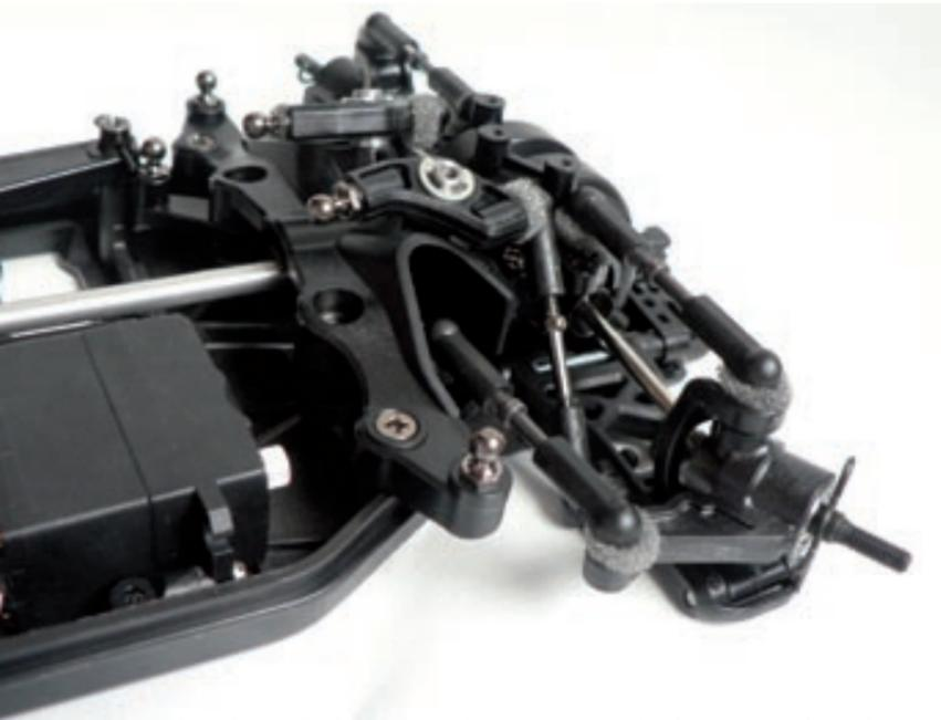
Wer ab und zu auf schmutzigen Pisten unterwegs ist, kann zum Schutz der Kugelhöpfe kleine Schaumgummiringe aus dem Offroad-Bereich verbauen. Nebenbei sorgt die Befestigung der vorderen Dämpfer für eine massive Versteifung des vorderen Chassisteils
