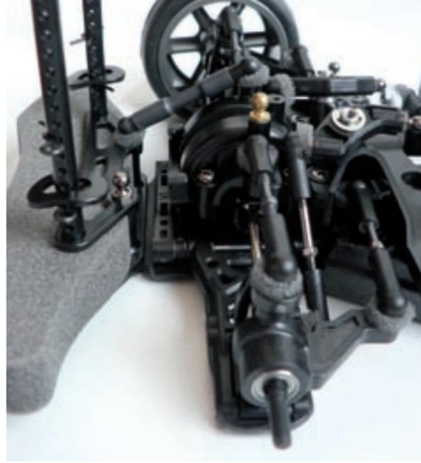
Der vordere Rammschutz sollte wie im Bild gezeigt verstärkt werden. So wird bei einem Crash ein Bruch der Chassiswanne wirkungsvoll verhindert
