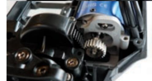
Die Lagerung der mehrteiligen Kardanwelle mit dem Hauptzahnrad erfolgt zusammen mit dem Motor in einer sehr verwindungssteifen Einheit aus Gussaluminium. Das Getriebe lässt viele Unterstellungen zu, daher lassen sich auch potentere Motoren optimal einsetzen, ohne Hitzeprobleme befürchten zu müssen
