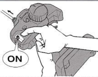
① 送信機のアンテナをのばし、スイッチをONにします。
