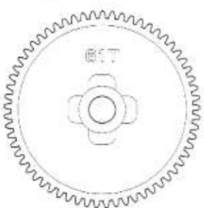
GB5 61Tスパーギヤ 61T Spur gear 61Z Stirnradgetriebe Pignon intermédiaire 61 dents ×1
