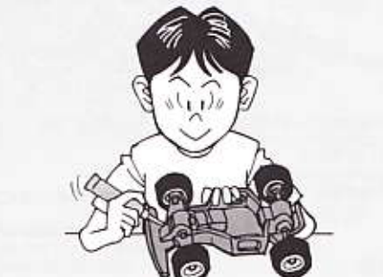
⑧ ギヤや軸受け部、サスペンションなどの可動部はグリスをさしておきましょう。
