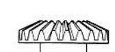
MA17 ×4 50602 大ベベルギヤ Large bevel gear Kegelrad groß Grand pignon conique
