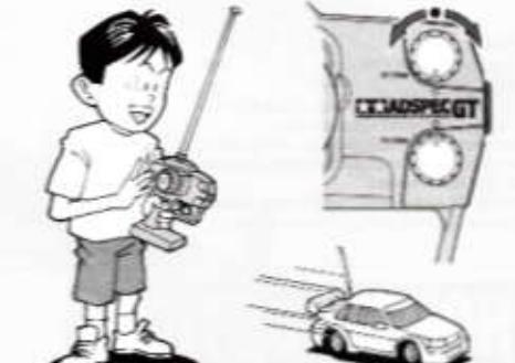
④ ステアリングを使わずに走らせてみます。まっすぐに走らない場合はステアリングトリムを使って調整して下さい。
