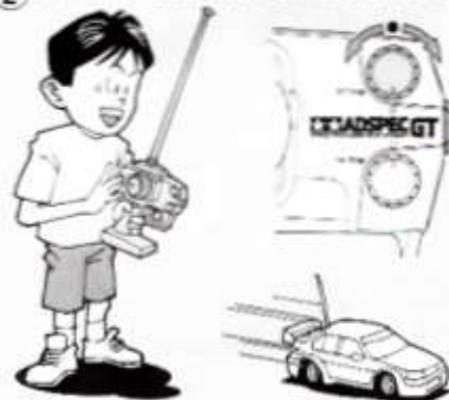
④ ステアリングを使わず走らせてみます。まっすぐに走らない場合はステアリングトリムを使って調節して下さい。
