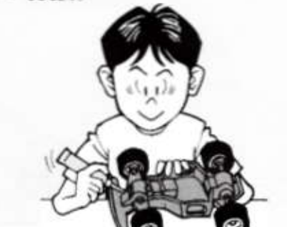
⑧ ギヤや軸受け部、サスペンションなどの可動部はグリスを塗っておきましょう。
