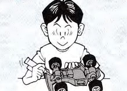
⑧ ギヤーや軸受け部、サスペンションなどの可動部はグリスを注しておきましょう。
