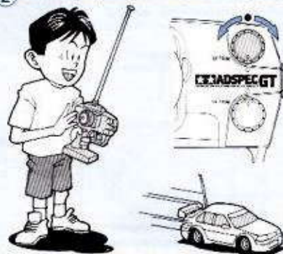
4 ステアリングを使わず走らせてみます。まっすぐに走らない場合はステアリングトリムを使って調整して下さい。
