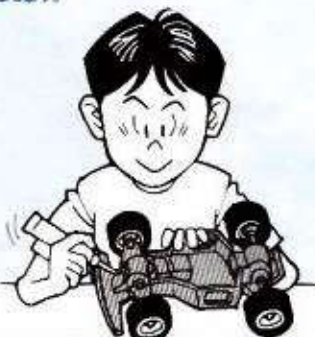
8 ギヤーや軸受け部、サスペンションなどの可動部はグリスを注しておきましょう。
