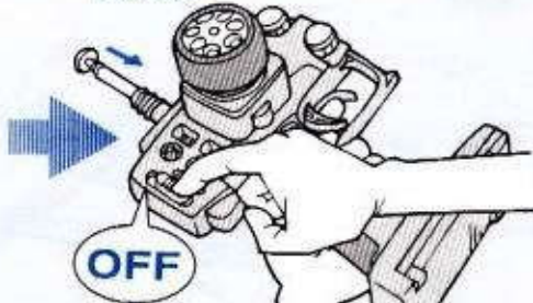
5 走行を終わらせる時は、かならず走らせる時の逆の手順でスイッチを切っていきます。
