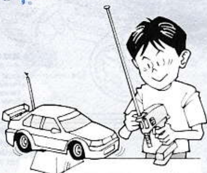
③ 走らせる前にRCカーを台の上に乗せ、各部の動きをチェックします。
