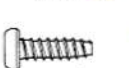
MA3×3 3×10mmフランジタッピングビス Flange tapping screw Kragenschraube Vis taraudeuse à flasque
