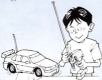
3 走らせる前にRCカーを台の上に乗せ、各部の動きをチェックします。
