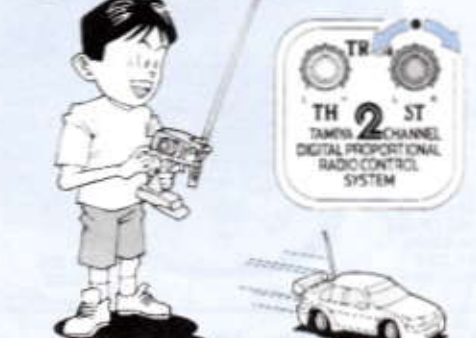
4 ステアリングを使わず走らせてみます。まっすぐに走らない場合はステアリングトリムを使って調節して下さい。
