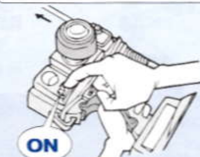
1 送信機のアンテナをのばし、スイッチをONにします。
