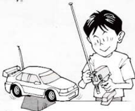
3 走らせる前にRCカーを台の上に寄せ、各部の動きをチェックします。
