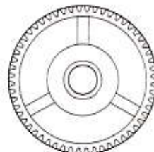
デフキャリア × 1 Differential spur gear Differentialrad Couronne de différentiel 9335097
