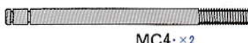
MC4 ・×2 リアダンパーシャフト Rear damper shaft Hintere Kolbenstange Axe de piston arrière
