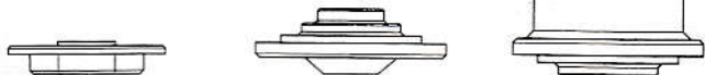
BF1 プレッシャープレートキャップ .....×1 Pressure plate cap Drucklagerplatten-kappe Capot du plaque de pression BF2 プレッシャープレートB .....×1 Pressure plate B Druckplatte B Plaque de pression B BF3 プレッシャープレートA .....×1 Pressure plate A Druckplatte A Plaque de pression A
