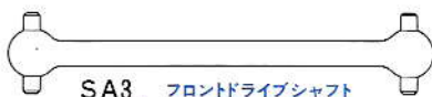
SA3 フロントドライブシャフト .....×2 Front drive shaft Vordere Antriebswelle Arbre d'entraînement avant
