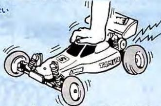
3段変速スイッチが最高速に入らない状態で長く走行させるとやはりレジスターが過熱します。又スイッチの調節不良のときも同じです。
