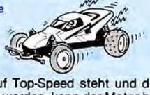
Wenn der Fahrregler auf Top-Speed steht und die Räder plötzlich blockiert werden, kann der Motor beschädigt werden oder durchbrennen. Motor-Strom darf Höchstwert nicht überschreiten.
