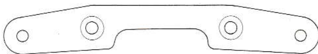
BP10 .....×1 4305236 ステアリングプレート Steering plate Lenkerplatte Plaquette de direction
