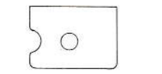
BP7 .....×1 4305238 Rダンパーステー(R) Right rear damper stay Hinterer Dämpfer-Halter rechts Support d'amortisseur arrière droit
