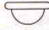
BS7 .....×2 Fオイルシール(グレイ) 6275020 Oil seal (gray) Ölabdichtung (grau) Joint d'étanchéité (gris)
