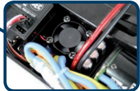
Der 100-Ampere-Regler wird über einen integrierten Lüfter gekühlt und ist für Eingangsspannungen bis 7,2 Volt ausgelegt
