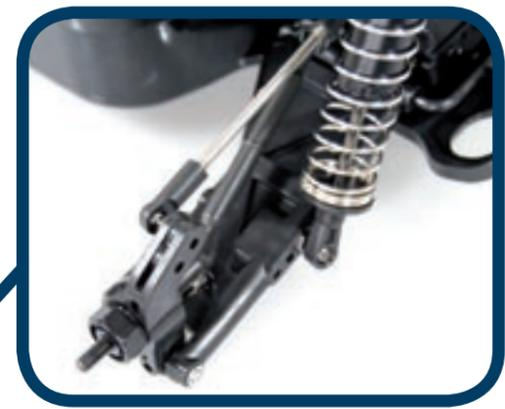
An der Hinterachse ist der Sturz ebenfalls über Gewindestangen stufenlos einstellbar
