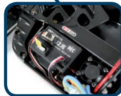
Der Zwei-Kanal-Empfänger arbeitet im 27-Megahertz-Band und verfügt über einen einfachen Ein-aus-Schalter
