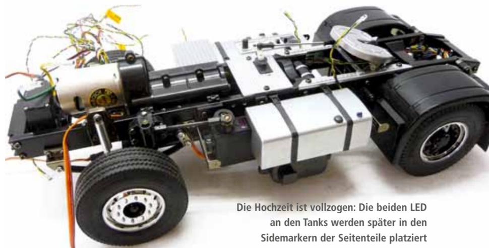
Die Hochzeit ist vollzogen: Die beiden LED an den Tanks werden später in den Sidemarkern der Seitenteile platziert
