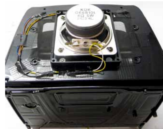
Der Lautsprecher kann für die bessere Optik im Innenraum von oben auf das Fahrerhausinnendach geschraubt werden
