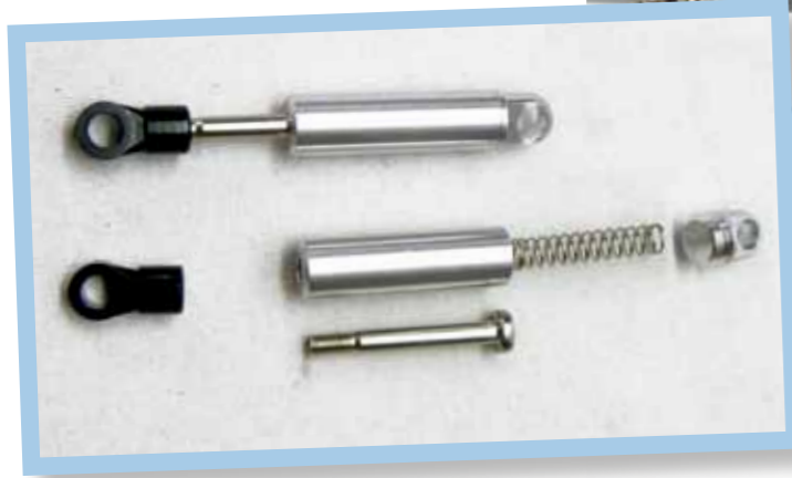
Die in Silber eloxierten Stoßdämpfer werden innen mit einer Feder versehen, um so die Blattfedern zu unterstützen. Eine dämpfende Funktion haben sie nicht
