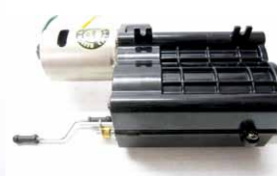
Um keinen Kontakt mit der Spurstange zu bekommen, kann die vordere Verschraubung getrost abgetrennt werden
