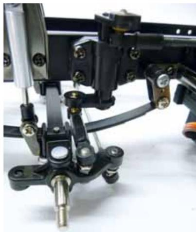
Um eine vorbildgetreue Lenkung zu ermöglichen, wurden die beiden Achsschenkel um 180 Grad gedreht eingebaut
