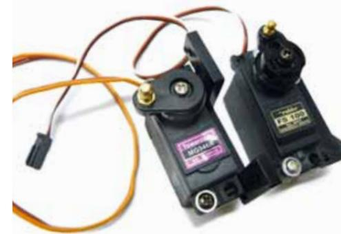
Für die Lenkung sollte schon ein 9-Kilogramm-Servo herhalten. Der Schaltung reicht ein Standard servo
