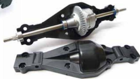
Das komplette Differentialgetriebe besteht aus Metallteilen. Um einen reibungslosen Betrieb zu gewährleisten, kann eine großzügige Schmierung nicht schaden
