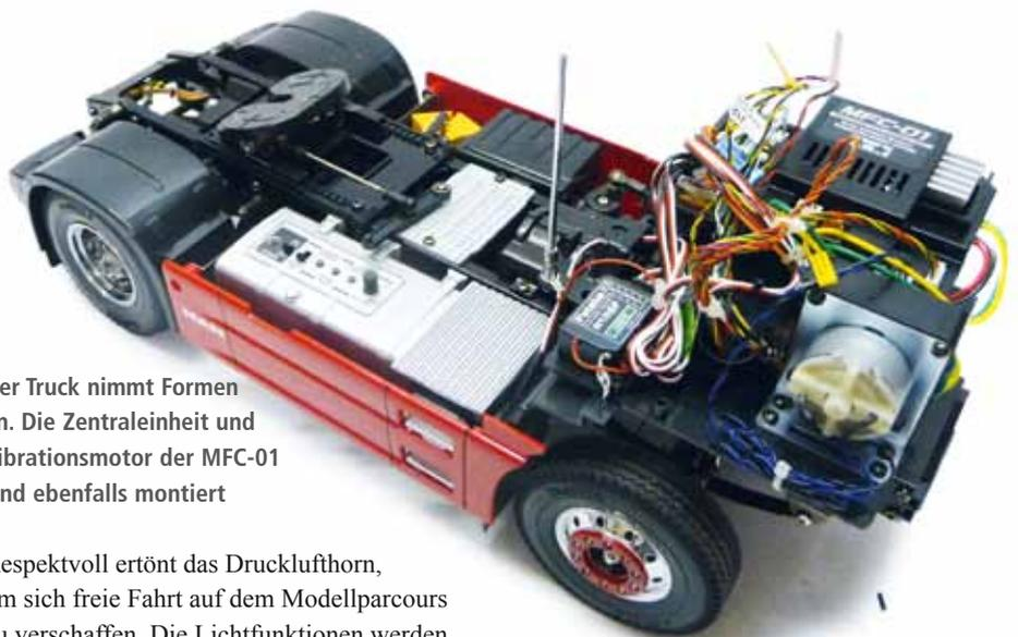
Der Truck nimmt Formen an. Die Zentraleinheit und Vibrationsmotor der MFC-01 sind ebenfalls montiert
