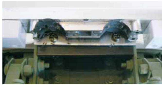
Mit zwei selbstschneidenden Schrauben wird der Rückleuchtenträger am Container-Chassis befestigt
