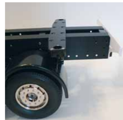
So weit muss die Twistlock-Aufnahme nach vorne
