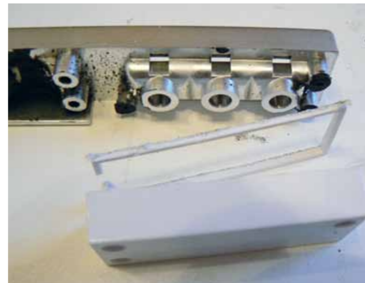
Bearbeiten der Rückleuchten, damit sie zwischen die Kotflügel und Rückleuchenträger passen
