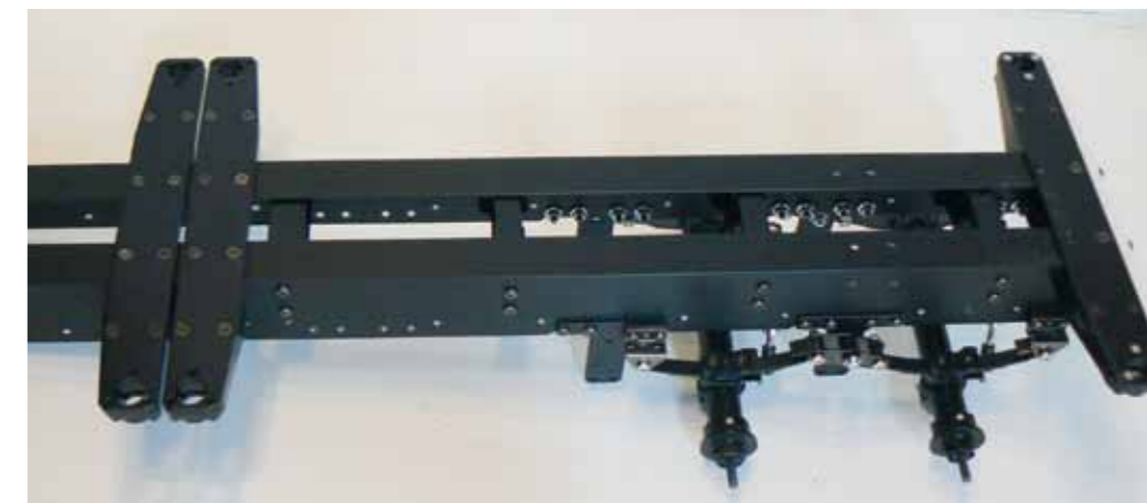
Demontage des ersten Achsaggregats
