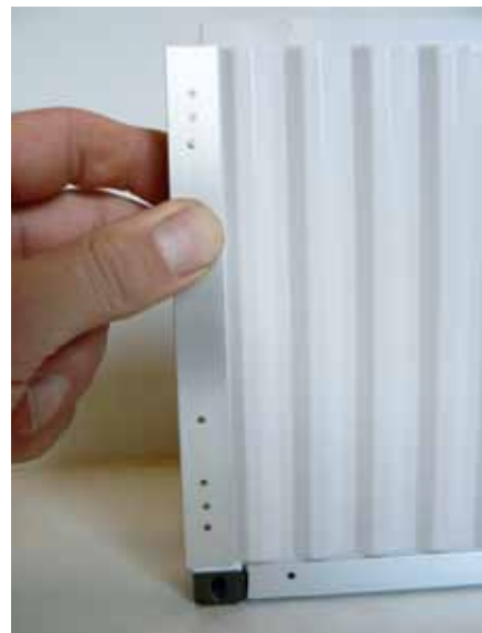
Anpassen der Container Außenecken
