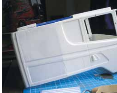
Marke Eigenbau: Sicken aus Polystyrol überbrücken den Zwischenraum
