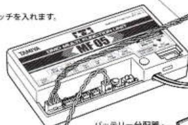
④ CN4スピーカー用ソケットにスピーカーユニットを接続します。
