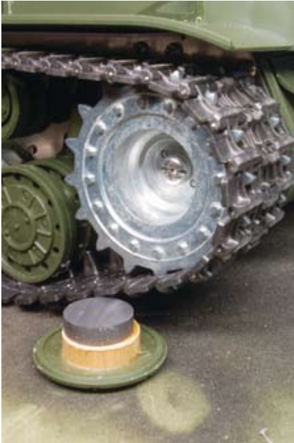
Die Nabendeckel halten mit Dauermagneten zuverlässig an den Kettenrädern
