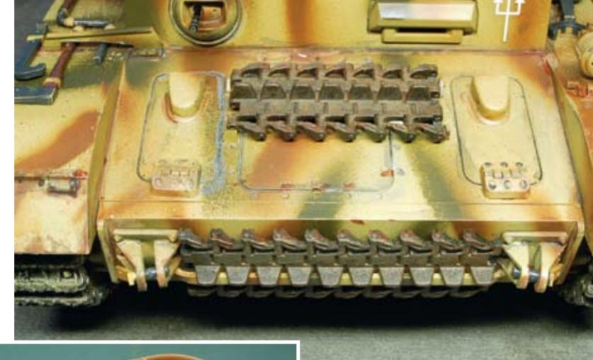
*Frontpartie mit ausgeklügelter Aufbauverschraubung. Die Scharniere für die Lenkbremsenklappen tragen Schrauben, die in die Unterwanne eingreifen*
