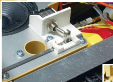
*Neben dem Schalter, jedoch ein Stockwerk tiefer, wurde der Wannenaufbau durchbohrt und dahinter auf der Kettenabdeckung eine Ladebuchse platziert*
