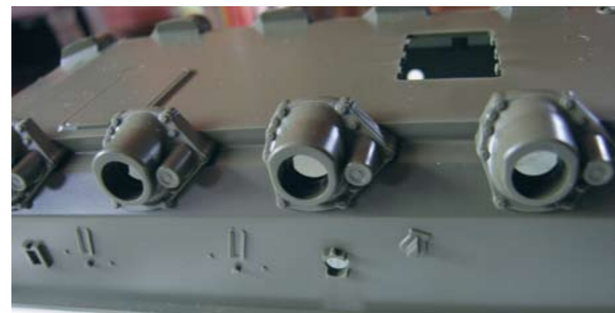
An diesen Aufhängungen werden die 14 Laufräder des Leopards befestigt
