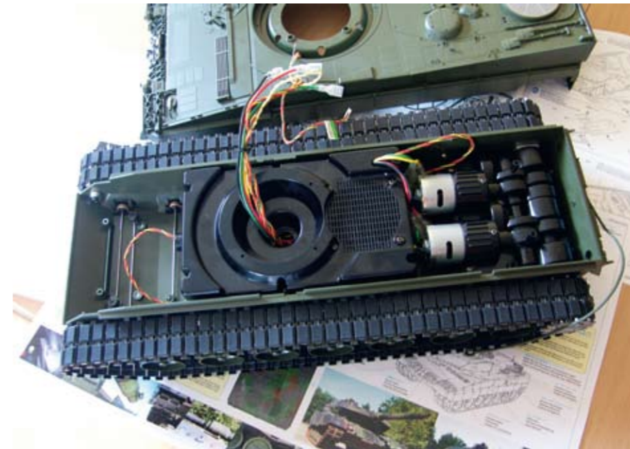
Die Kabel der Lautsprechereinheit führen in den Turm, wo beim Leo-Modell auch der Akku untergebracht ist
