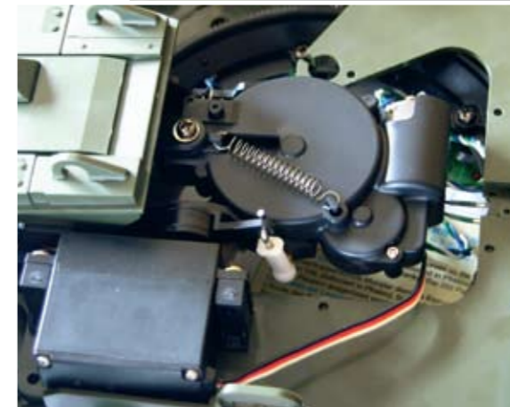
Die Rückstoßeinheit der Kanone. Unten links befindet sich das Servo zur Verstellung des Kanonenrohrs
