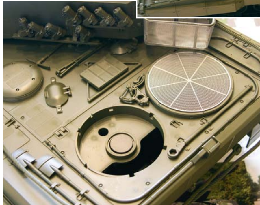
Der montierte Kühlergrill am Fahrzeugheck. Dank der Magnete kann man auch schnell einen Blick ins Fahrzeuginnere werfen
