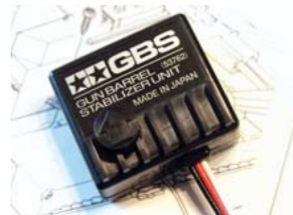
Die Waffenstabilisierungseinheit von Tamiya – mit Lagereglern aus dem U-Boot-Modellbau lässt sich das Ganze auch kostengünstiger realisieren
