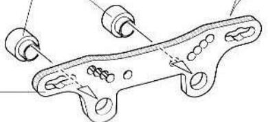
**2** 《OP. 571 TRFダンパーの標準位置への取り付け》
