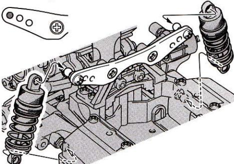
●このセットに使用できるダンパーはOP.1000Mシャーシ用ハイグレードダンパーのようなピローボール対応のダンパーになります。
