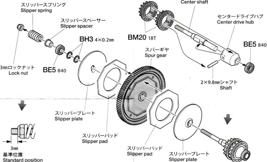
★基準位置からナットをゆるめるとスリッパーがすべりやすいセッティングとなります。スリッパーがすべっている状態で走行を続けると過熱によりスパーギヤが溶けることがありますので避けてください。
