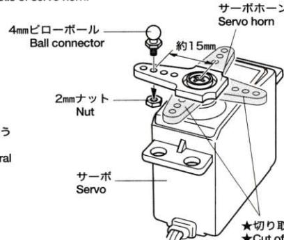
★サーボと砲塔スイッチのニュートラル位置が合うようロッドの長さやサーボの位置を調節し、取り付けます。
