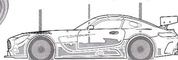
★スナップピンの位置は、ボディがタイヤや路面に接触しない高さに取り付けてください。
